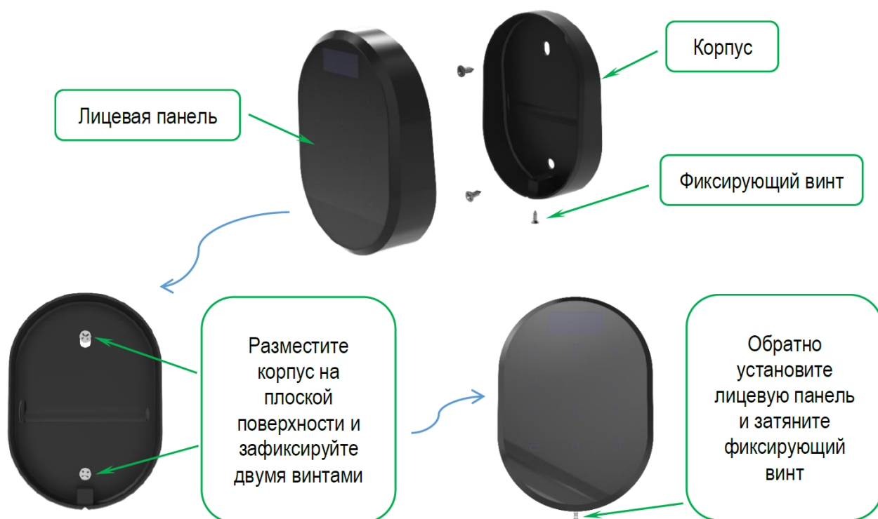
Рисунок 3 – Порядок установки кодовой панели
