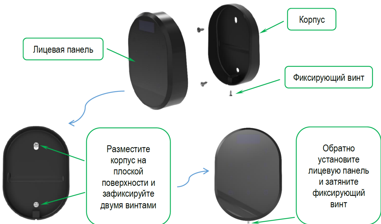
Рисунок 3 – Порядок установки кодовой панели
